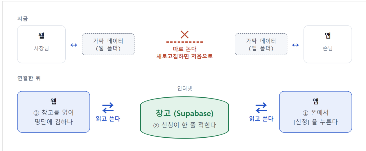
그림 21-1 지금과 연결한 뒤. 지금은 웹과 앱이 각자 가짜 데이터 파일을 들고 있어 서로 모른다. 연결하면 둘 다 인터넷에 있는 창고 하나(Supabase)를 읽고 쓴다. 폰에서 신청하면 창고에 적히고, 웹은 그 창고를 읽어 명단에 보여준다
