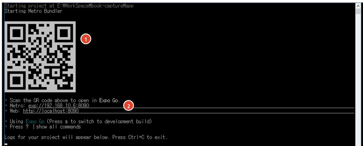
그림 17-3 개발 서버를 띄우면 컴퓨터에 뜨는 QR 코드. ① 폰의 Expo Go 로 이 QR을 찍는다 ② QR 안에 든 주소 — 컴퓨터의 와이파이 주소라서 폰이 같은 와이파이에서 찾아온다
